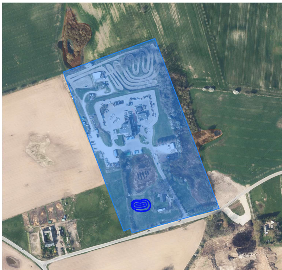
Figur 1: Afgrænsning af opland ALM02SN, med ca. placering af det nye forsinksesbassin.
